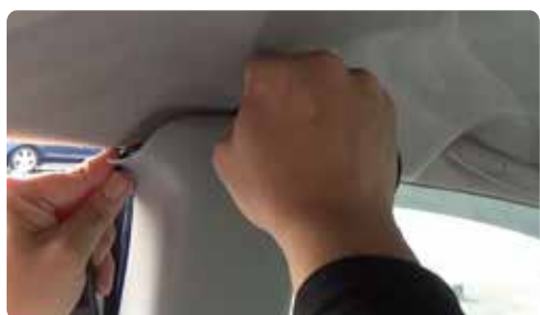
⑤センターピラーに配線
