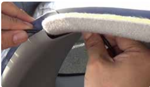
⑨隙間に配線
