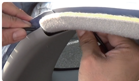
⑨隙間に配線
