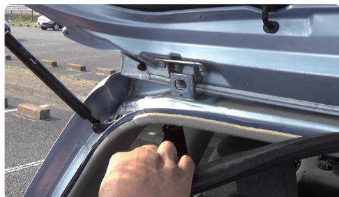
⑧バックドアへ配線
