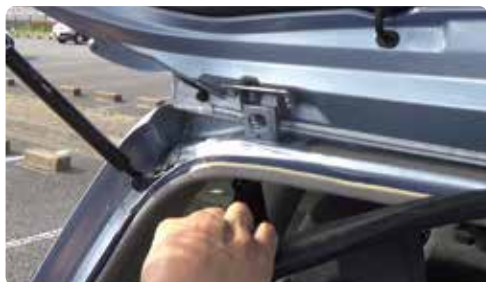
⑧バックドアへ配線
