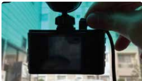
①電源ケーブルを本体に配線
