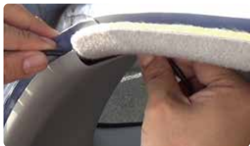
⑨隙間に配線
