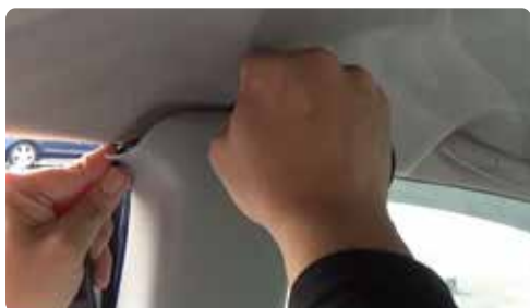
⑤センターピラーに配線
